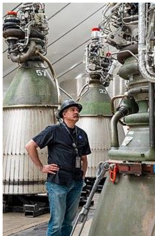
Raptor 2 Vacuum (sullo sfondo) e un Raptor 2 a livello del mare (in primo piano).
