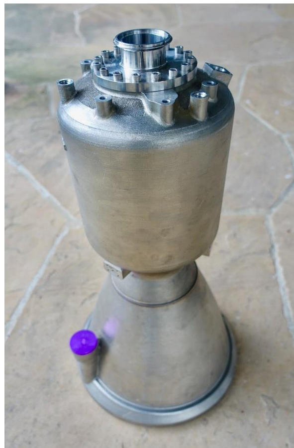
Esempio di un motore a razzo Astra realizzato in Inconel.
