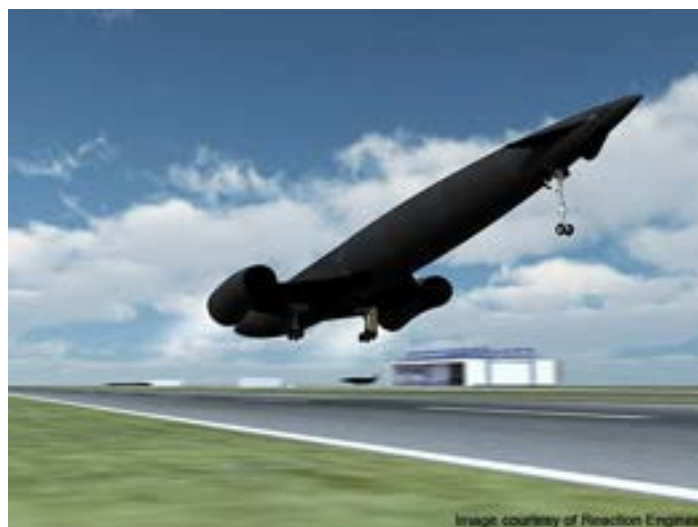
Rendering del velivolo Skylon della Reaction Engines Limited (UK), dotato di motori ibridi jet-ramjet-razzo: i SABRE (Synergetic Air Breathing Rocket Engine)
