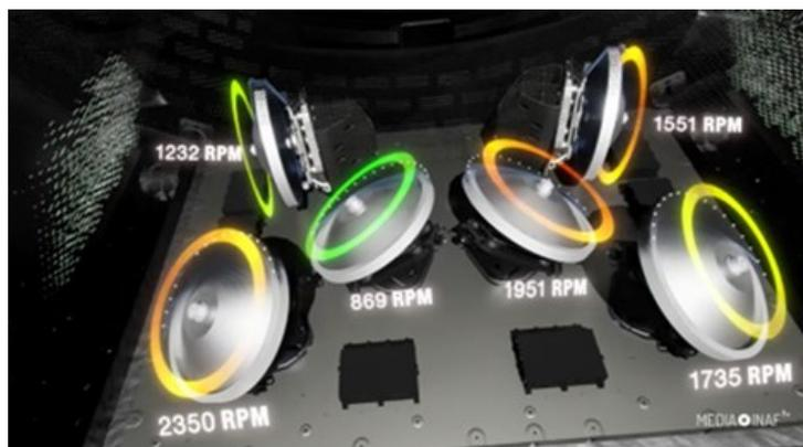
Figura 20: le sei ruote di reazione (Reaction wheels) di WFIRST
