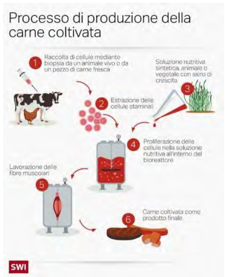
Figura 5.4 Processo di produzione della carne coltivata
