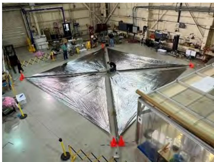
Figura 3.5 L'Advanced Composite Solar Sail System prima della sua installazione sul satellite
