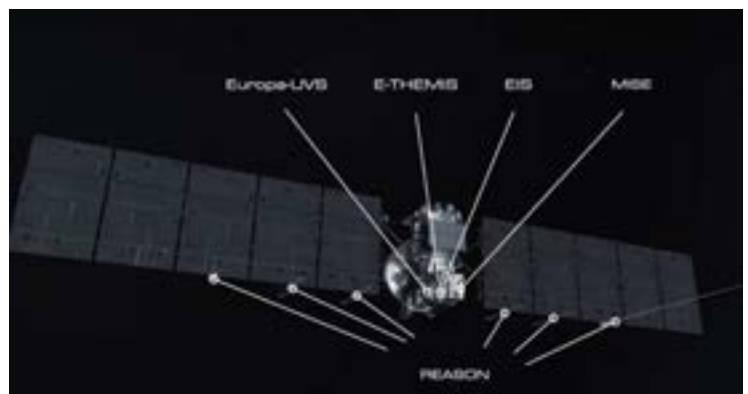
Le due immagini fig. 11.1. (sopra) e 11.2 (sotto) evidenziano la posizione fisica degli strumenti sulla sonda Europa Clipper
