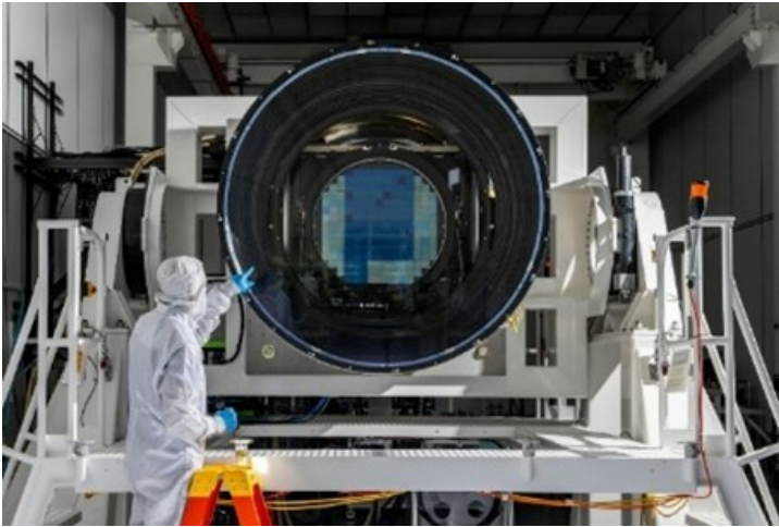
Figura 6.3 Fotocamera del Vera C. Rubin Observatory, presso lo SLAC di Palo Alto
