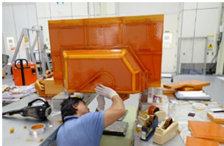
Figura 8.1 - Mozany Sosmath prepara un segmento dell'isolamento in schiuma di Dragonfly per i test nella Titan Chamber presso il Johns Hopkins Applied Physics Lab. (Credit: Johns Hopkins APL/Justin Artis)
