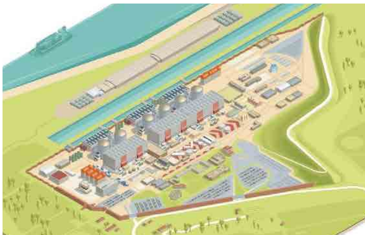
Figura 3: Schema planimetrico della centrale di Gravelines con i sei reattori e le infrastrutture collegate. Credit: Comité Local d'Information (CLI) de Gravelines, dicembre 2021
