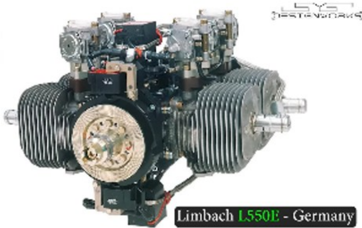
Figura 4.21 Il motore quattro cilindri due tempi del Shahed-136
